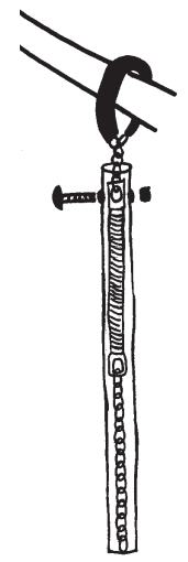
Figura 7. Un tub de PVC cu diametru îngust ascunde un arc pentru poartă de garaj pentru ca tigrul să nu-și prindă ghearele, buzele etc. în arc. Tubul de PVC are de două ori lungimea arcului, astfel că și dacă este întins la maxim, arcul să rămână complet în PVC (Hare și Jarand, 1998).
